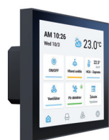
RF Touch-B Ovládací dotyková jednotka – do instalační krabice
