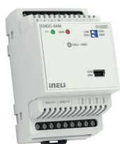
EMDC-64M Převodník iNELS - DALI/DMX
