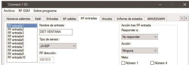
Dib. 27: Pestaña "Entradas RF" asignación del detector al RFGSM-220.
