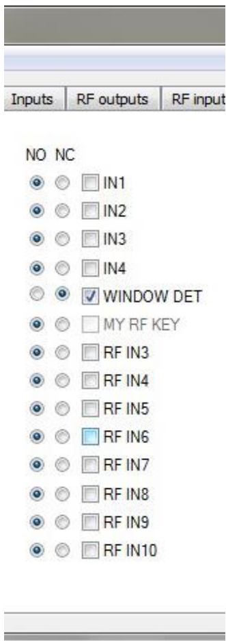
Rys. 30: Zakładka "ARM/DISARM" – wybór wejść w nadzorowanej strefie i ustawienie parametru.
